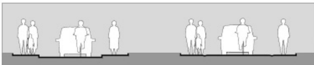
Exemplo de partilha de via entre modo ciclável e automóvel em zonas 30 Circulação pedonal segregada em passeio ou berma
